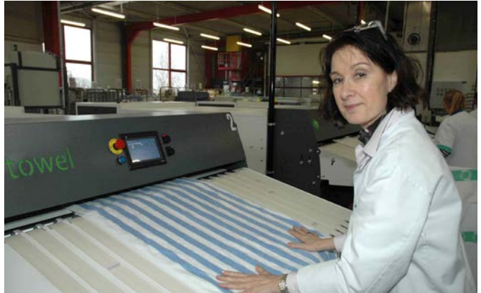
Die t.Towel Air sortiert sich die Teile automatisch nach Länge. Ein Vorsortieren ist nicht nötig.
